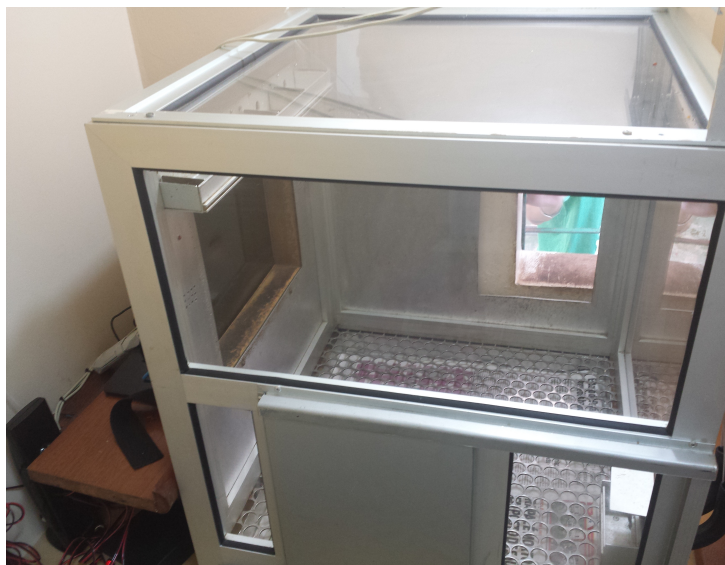
Figura 1. Câmara experimental (gaiola de testes) com a tela sensível ao toque acoplada.
